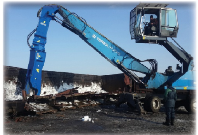
Рукоять, созданная на заказ специально для ножниц AS030
