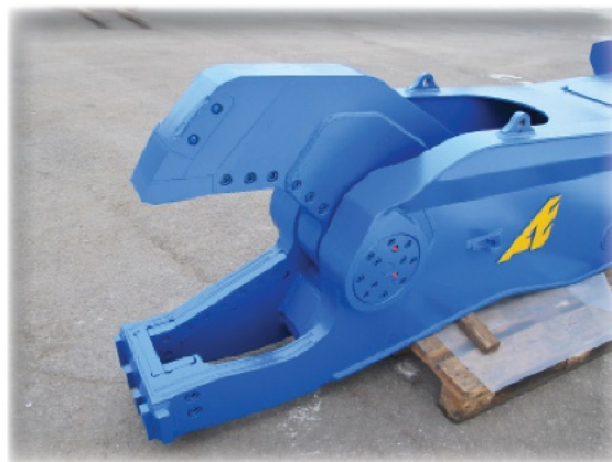
AS021 – Вид оси, закрепленной на подвижной челюсти
